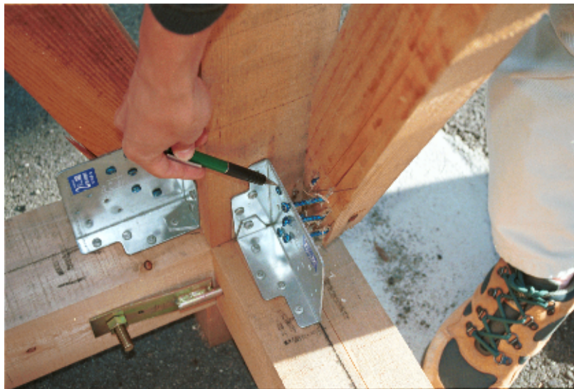
写真 9 H 棟：step114 で 1 階引張筋かいの下端部で接合部が外れた
