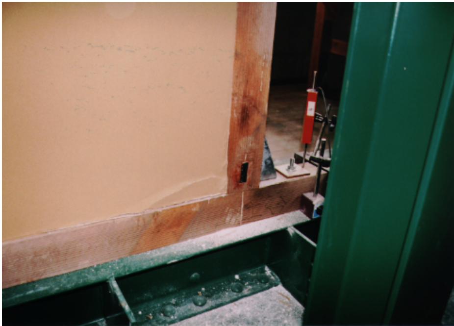
写真 27 試験体 No.1b: 隅角部での圧壊
