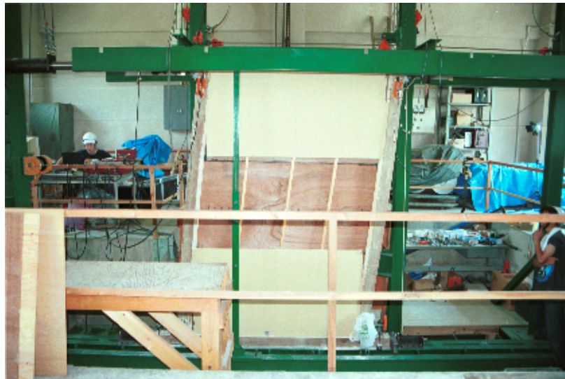
写真 33 試験体 No.4a: 中段石膏ボードが脱落
