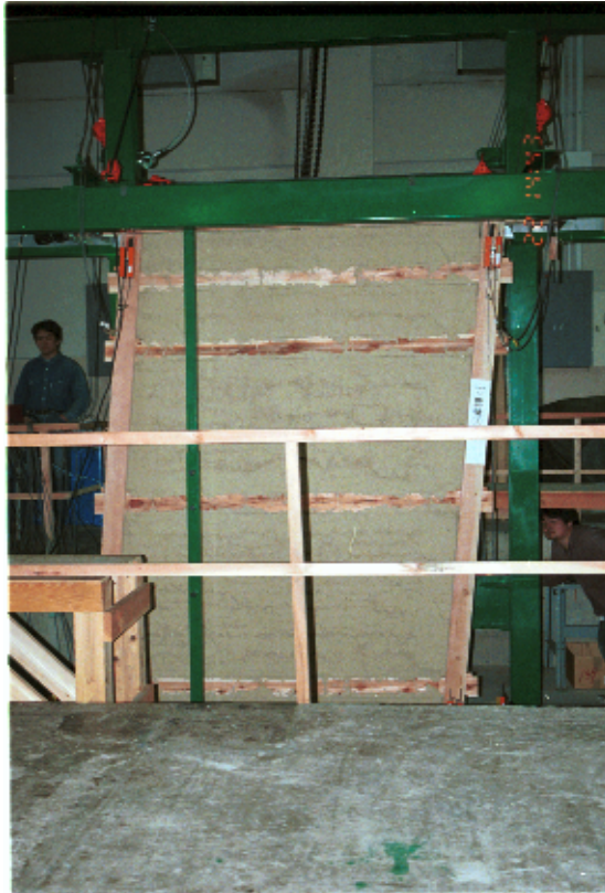
写真 17 試験体 No.3a 1/10rad 変形状態
