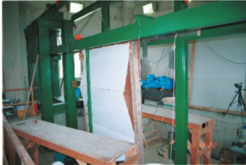
写真 31 試験体 No.3b: ラスボード脱落
