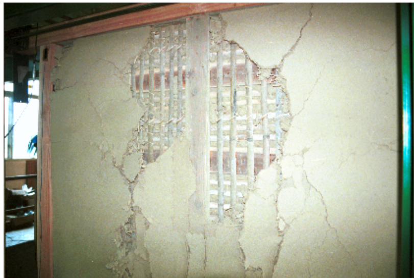
写真 18 試験体 No.4b 裏側で壁土が大きく剥落
