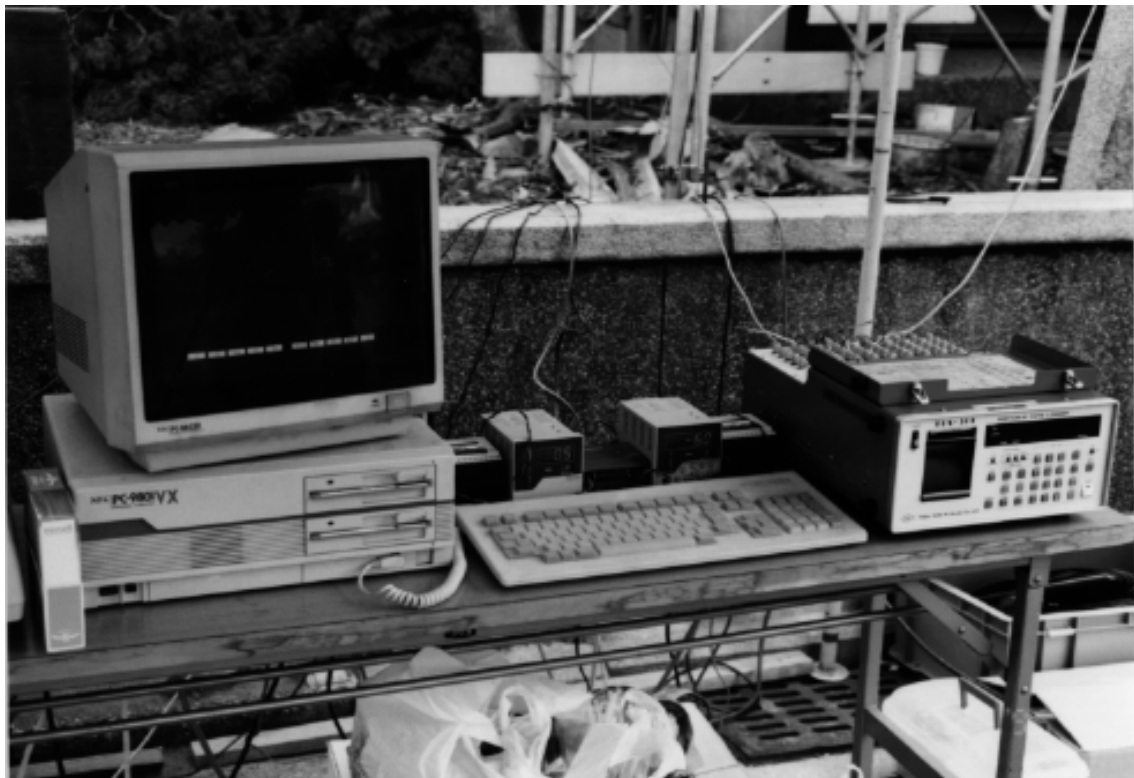
写真 3 引張破壊実験で使用した計測システム
